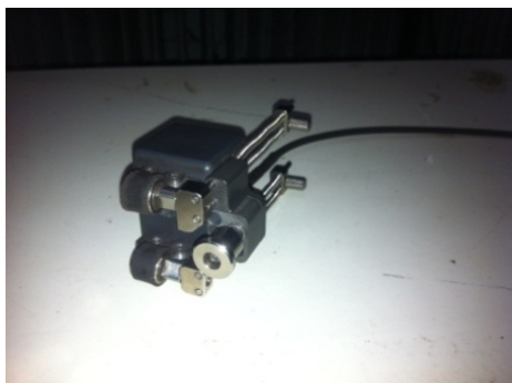
Slika 5.11 Ekstenziometar za mjerenja malih deformacija na sobnoj temperaturi
