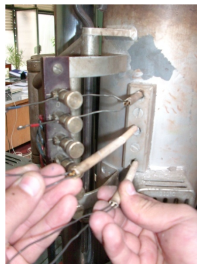
Slika 5.15 Ugradnja termoelemenata u tri zone peći
