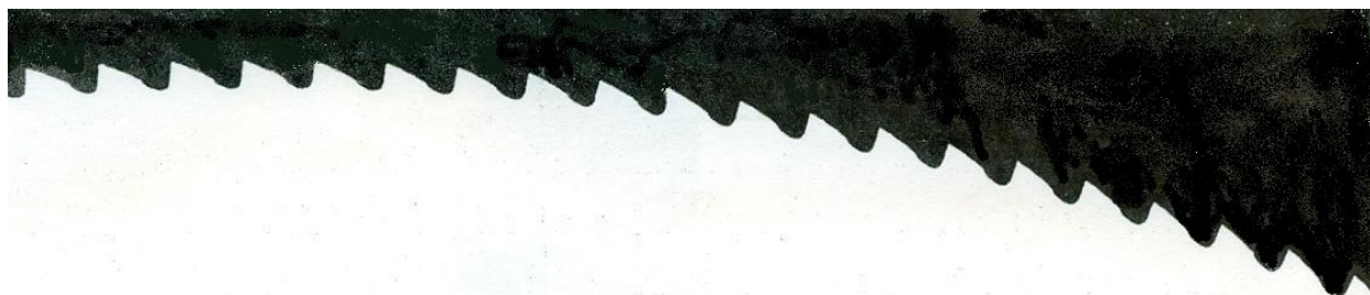
Slika 5.20 Pilni disk sa naoštrenim zupcima
