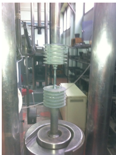
Slika 5.13 Ispitivanje zatezanjem na sobnoj temperaturi
