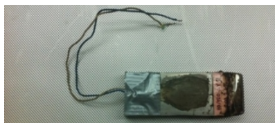
Slika 5.47 Jednoosna mjerna traka 10/120 LY11 koja služi kao senzor sile
