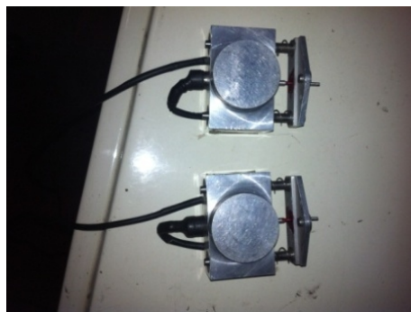
Slika 5.12 Ekstenziometar za mjerenja malih deformacija na povišenim temperaturama
