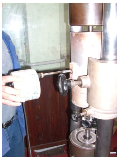
Slika 5.14 Montaža regulatora temperature u peć
