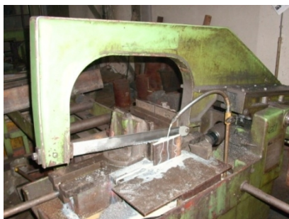
Slika 5.3 Odsijecanje stope šine UIC 60 na okvirnoj pili
