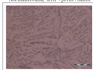
i) Grubozrnati dio ZUT-II Widmanstatten ferit + bainit + martenzit
