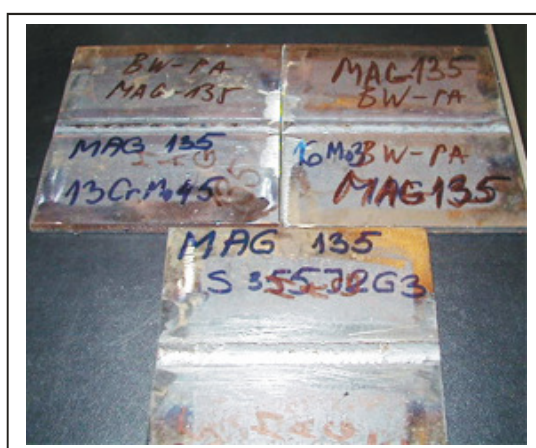
Slika II-3. Primjer zavarenih ploča MAG postupkom zavarivanja
