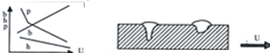
Slika A2. Uticaj napona zavarivanja na oblik zavara [38]
