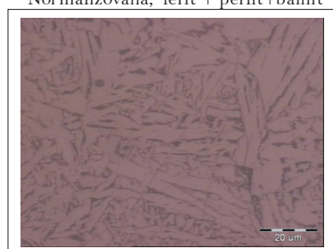
d) Grubozrnati dio ZUT-I Widmanstatten ferit + bainit + martenzit
