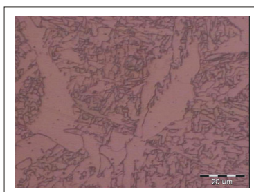
e) Metal zavara Livena struktura, ferit po granicama primarnih austenitnih zrna+ bainit
