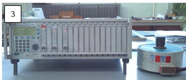
Slika II-6. Priprema prenosnog etalona za kalibraciju
