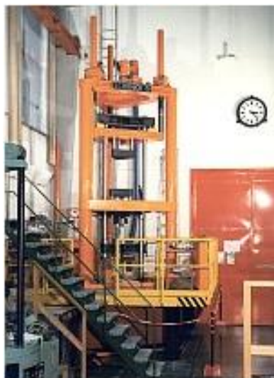
Slika I-5. Primarni nacionalni etalon sile od 1MN
