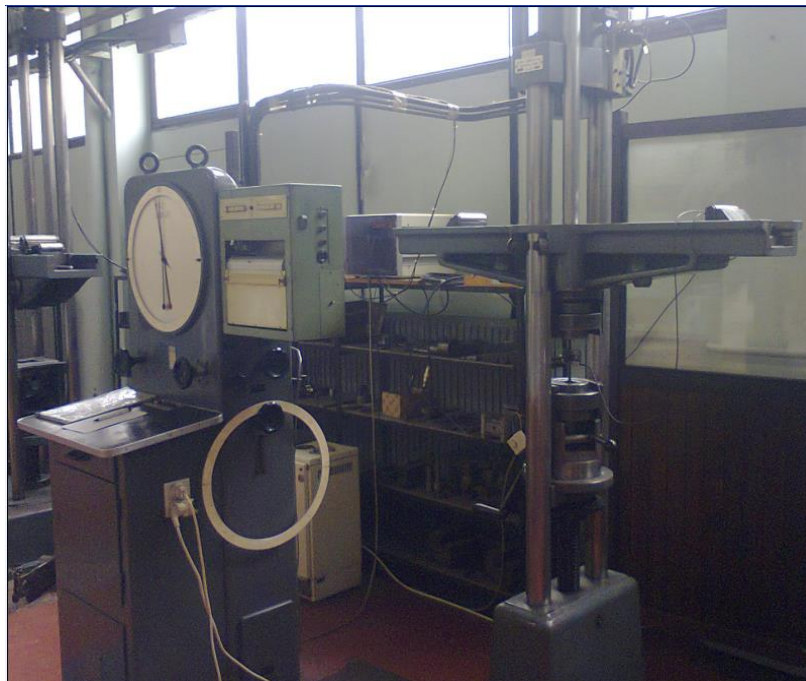
Slika I-11. Univerzalna hidraulična mašina za statička ispitivanja – kidalica od 200 kN
