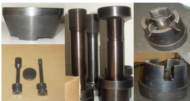
Slika II-9. Pristroji kod pozicioniranja mjernih ćelija u referentnu mašinu
