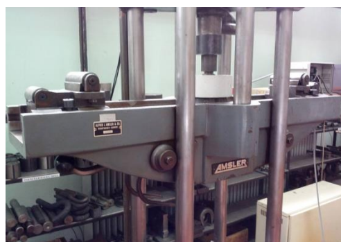
Slika II-40. Pozicionirana mjerna ćelija u kidalici
