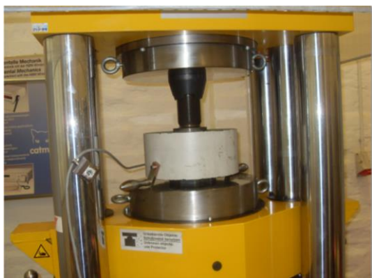
Slika II-7. Pozicionirana mjerna ćelija u referentnoj mašini
