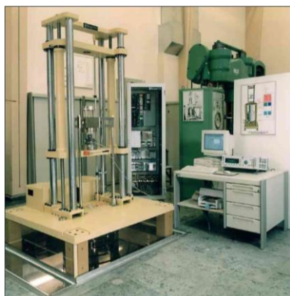
Slika I-6. Referentni etaloni sile sa direktnim opterećenjem tegovima [11, 14] a) od 100 kN
