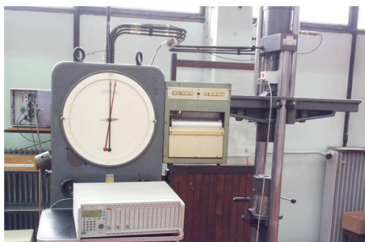
Slika II-40. Pozicionirana mjerna ćelija u kidalici
