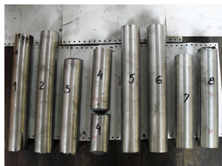
Slika 7. Uzorci nakon provedenog procesa kovanja i grube mašinske obrade [8]
