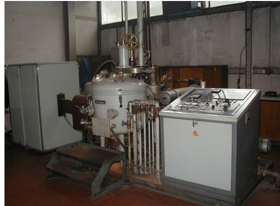
Slika 1. Vakuumska indukcijska peć (VIP) 20 kg
