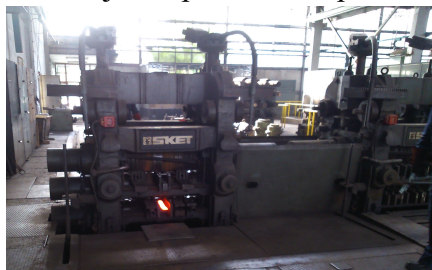
Slika 9. Valjanje uzoraka na SKET valjaonici
