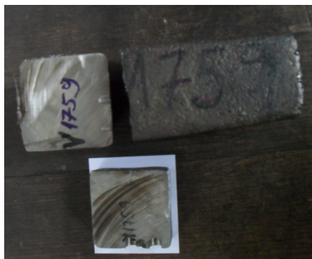
Slika 2. Ingot nakon rezanja ploče za metalografska ispitivanja [8]
