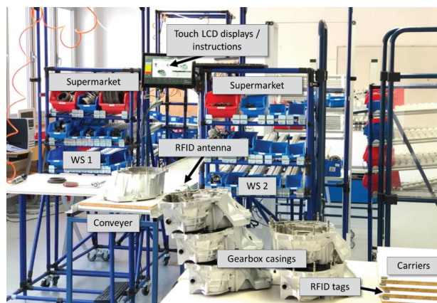
Slika 4: Montažna linija za mjenjač u skladu s trendovima Industrije 4.0
