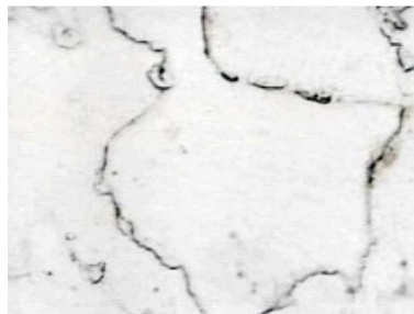
Promjena stanja mikrostrukture nakon više od 70 000 radnih sati
