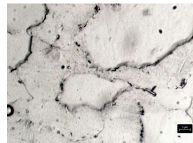
Promjena mikrostrukture nakon više od 150 000 radnih sati
