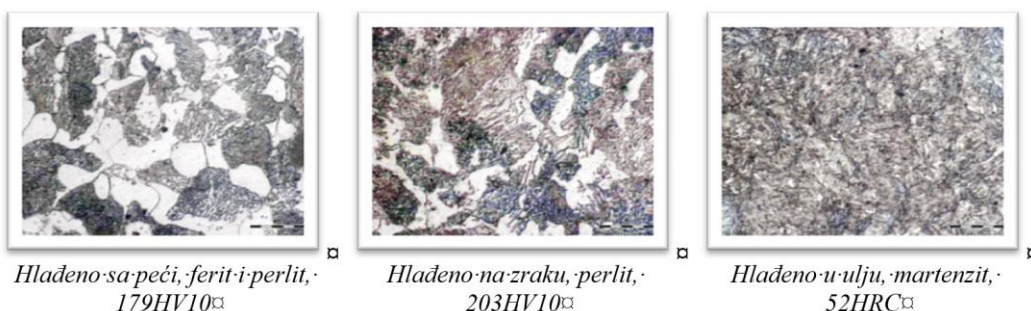
Slika 10. Makrostruktura termički tretiranog ugljeničnog čelika za poboljšanje C60[9]
