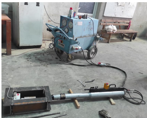
Slika 10. Kalibracija prese za prednaprezanje užadi sa pištoljima
