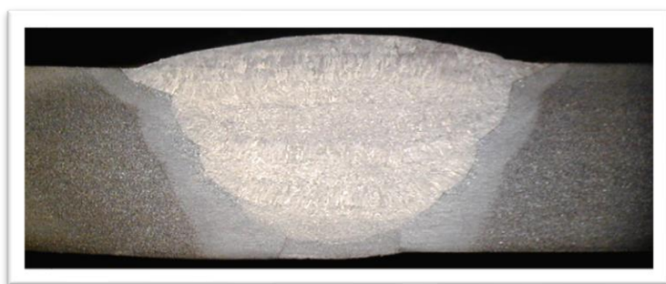
Slika 8. Makrostruktura zavarenog spoja S355J2G3[9]
