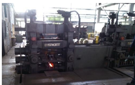
Slika 9. Valjanje uzoraka na SKET valjaonici
