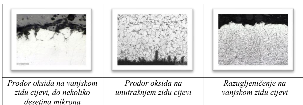
Slika 4. Izgled mikrostrukturnih promjena na zidovima cijevi [9]
