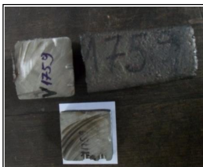
Slika 2. Ingot nakon rezanja ploče za metalografska ispitivanja [8]
