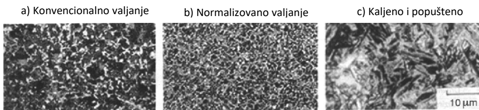
Slika 9. Mikrostruktura čelika kvaliteta 38MnSiVS5 za različite postupke valjanja i naknadnog termičkog tretmana [13]
