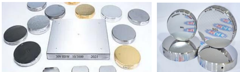
Slika 11. Referentne pločice za indirektnu kalibraciju aparata za ispitivanje tvrdoće
