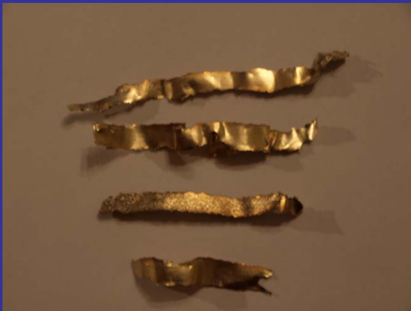
Livenja prisjetljivih slitina metodom melt spinner
