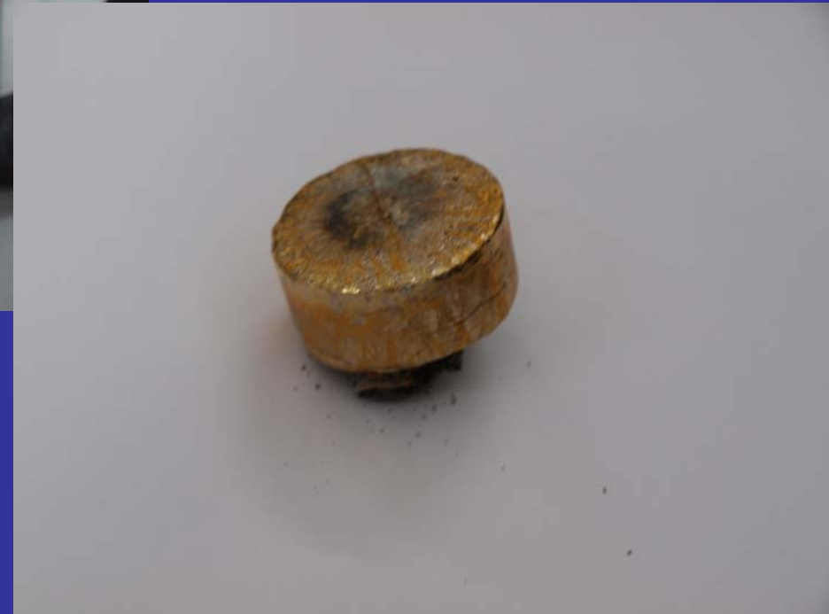
Fotografski snimci tijekom skrućivanja odljevka predlegure Cu13Al3.25Ni s efektom prisjetljivosti oblika
