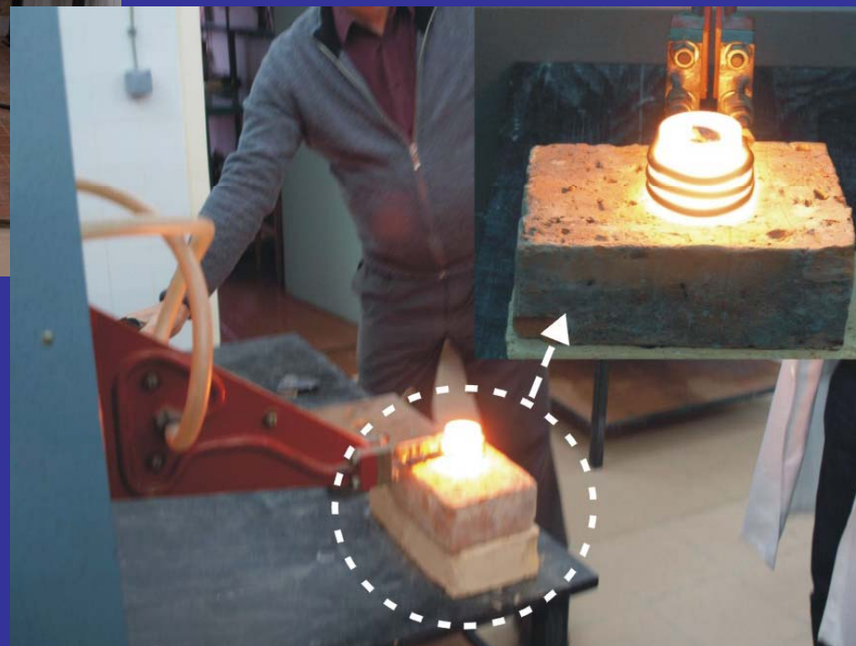
Pretaljivanje predlegure u visokofrekventnoj indukcijskoj peći
