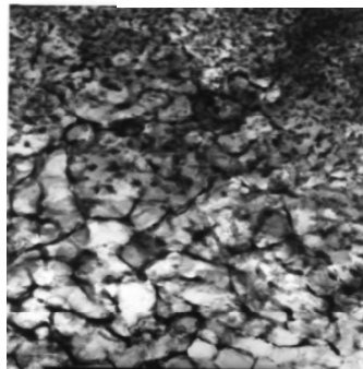
Mikrostruktura hitro strjene zlitine Al-Fe (a), žarjene na 480 °C (b) in žarjene na 580 °C (c). TEM.
